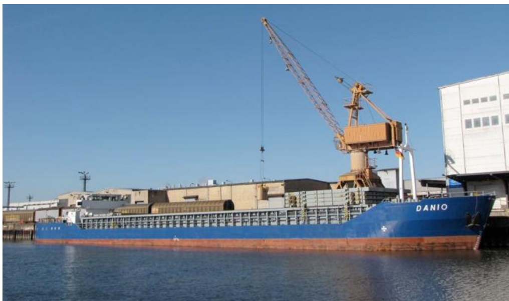
Abb. 14: MS DANIO am Bollwerk des Papierherstellers Leipa / Schwedt – Länge ca. 77 m – Breite ca. 11,4 m – Max. Tiefgang 3,25 m - max Tragfähigkeit ca. 1.800 t – Tragfähigkeit bei Abladung 2,70 m ca. 1.300 t (Quelle: WSV)
