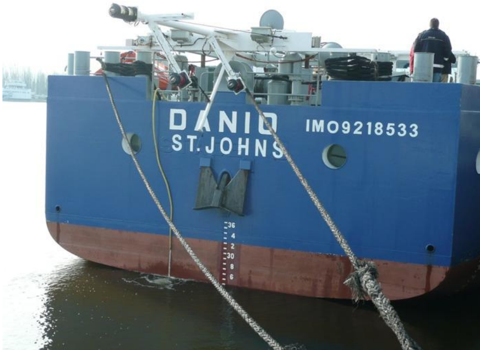
Abb. 15: MS DANIO in Stettin vor Antritt Ballastreife – Ballasttiefgang 2,70 m in Vorbereitung (Photo: Linde)
