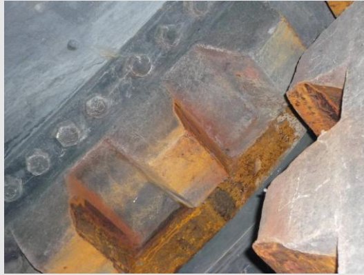
Schäden an Zahnkränzen und Verformungen der Laufschiene
