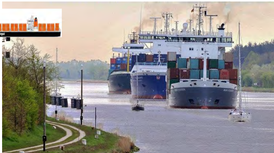
(7a) Nord-Ostsee-Kanal - Einfahrt von Containerschiffen in die Ostsee - zul. Größen 235 m x 32,5 m x 8,00 m x 40,00 m x ca. 1.000 - 2.000 TEU - Shortsea- + Feederschiffe (keine Deepsea-Schiffe im Direktanlauf Ostsee)
