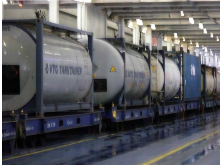
(16) Tankcontainer auf Bahn-Waggons an Bord Fährschiff „STENA SCANDINAVICA“ - 1 Deck mit Gleisanschluss - Affinität zum Schienenverkehr + u.U. Binnenschiff
