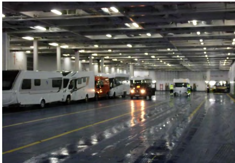
(13) Fahrzeugdeck Fährschiff „STENA SCANDINAVICA“ - flexible Stauung von Fahrzeugen je nach verfügbarer Deckshöhe
