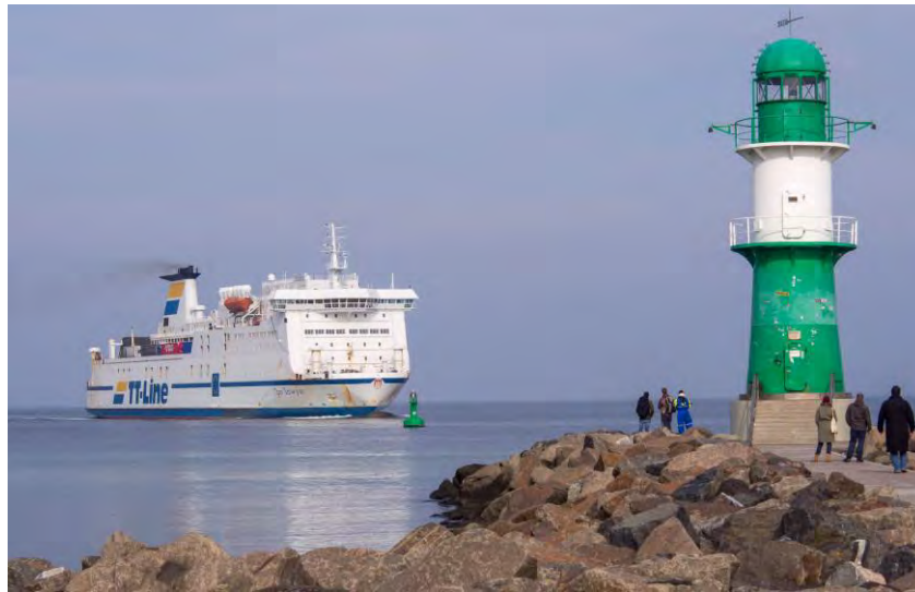
(11) „Fährschiff“: Transport von Personen + rollenden Gütern / Horizontal-Umschlag - Ostsee-Liniendienste - z.B. Warnemünde <> Gedser - ± Prioritäten für Güter + Personen
