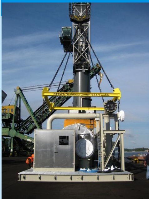
Przeladunek 90 tonowego elementu żurawiem Liebherr w porcie Świnoujście
