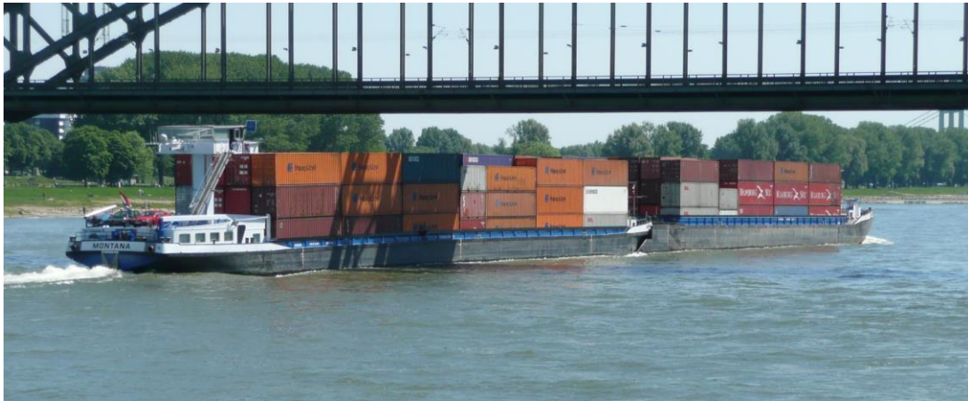
(12) Koppelverband auf dem Rhein – Motorschiff 110 m + Leichter 70 m
