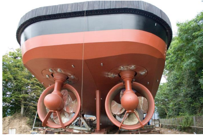
(25) Antriebs- + Manövriertechnik - Schottel-Antrieb für Schlepper, Schubboote
