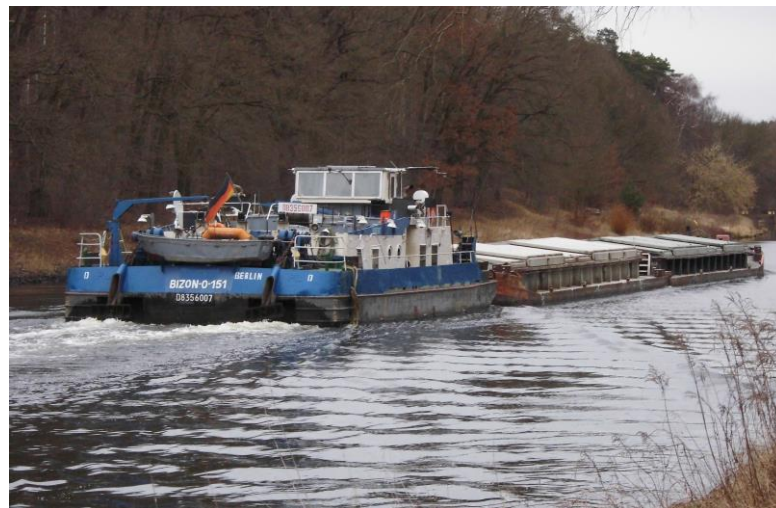
(10) Kleiner Schubverband auf dem Teltowkanal / Berlin – 2 x 32,50 m x 8,20 m
