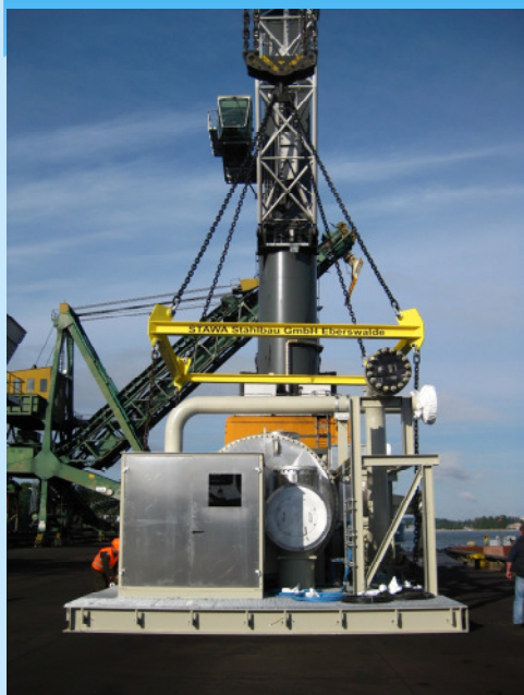
Przeładunek 90 tonowego elementu żurawiem Liebherr w porcie Świnoujście
