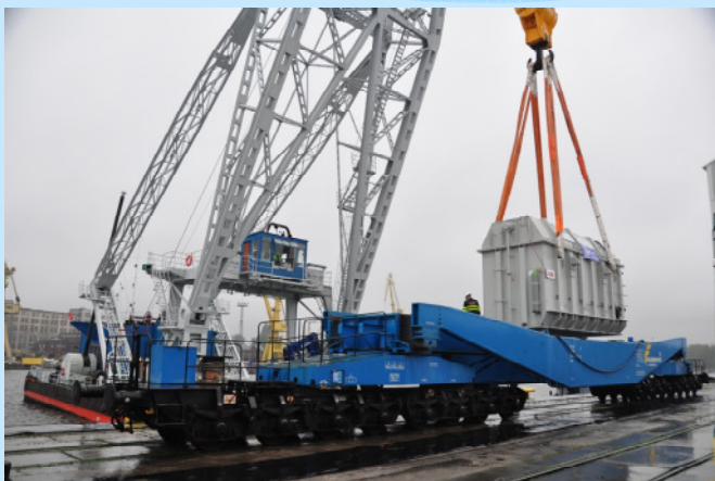
Przeładunek transformatora 113 ton żurawiem pływającym Lodbrok w porcie Szczecin
